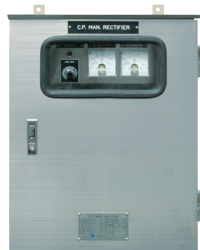
누설전류로 인한 파이프라인의 부식을 방지하기 위한 배류용 정류기 / Impressed Current Drainage System Panel Unit for Pipeline Protection Against Stray Current
