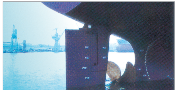
ALUNODE로 방식되는 선미부 Ship Stern Parts Protected by ALUNODES
