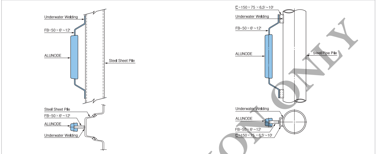
강재파일용 ALUNODE 설치 / INSTALLATION OF ALUNODE FOR STEEL PILE
