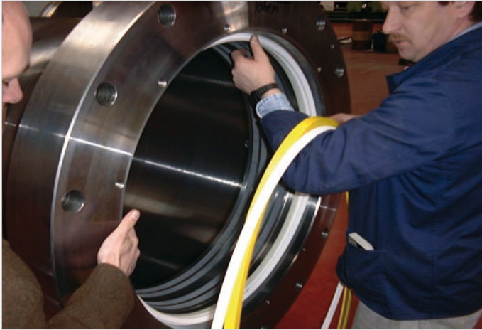
Dichtungswechsel an einem Großzylinder Seal change on a huge cylinder
