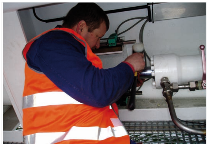
Dichtungswechsel an einem Verriegelungszyylinder Seal change on a locking cylinder
