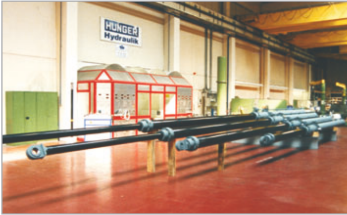
Teleskopzylinder für Radialschützbetätigung, Cachi Damm, Costa Rica
