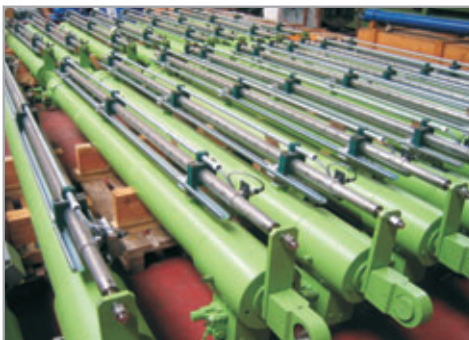
Hydraulikzylinder für Stahlwasserbautore mit Positionsmessstange und einstellbaren Endschaltern
