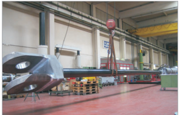
Hydraulikzylinder für Turbinen-Einlaßschütz mit 17.550 mm Hub
