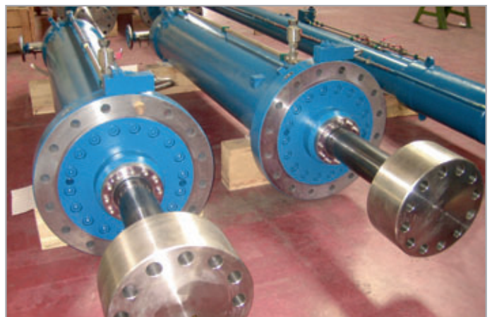
Hydraulikzylinder für Turbinen-Einlassschütz Hydraulic cylinder for power intake gate
