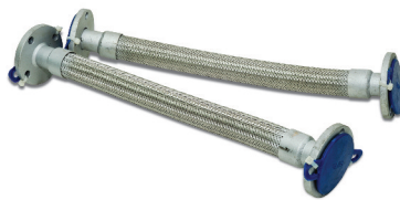
FLEXIBLE METAL HOSE SIZE : 1/4"~2" MAX W.P : 110kg/cm 2 WORKING TEMP : -23~204°C
