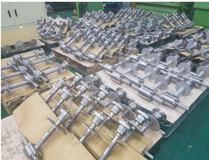
Side Entry, Floating Ball Class 800/1500 2" Below - KOGAS, LNG Terminal
